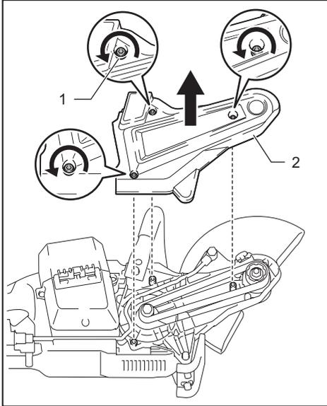
► 1. Perno de cabeza hexagonal 2. Cubierta
