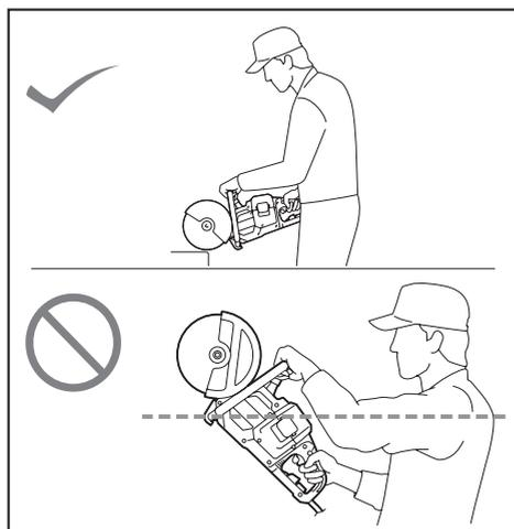
Sostenga la herramienta firmemente. Agarre el mango con su mano derecha y la empuñadura con su mano izquierda. Para evitar descargas eléctricas al cortar accidentalmente un cable eléctrico, sostenga siempre la empuñadura por la porción designada, como se muestra en la figura.
