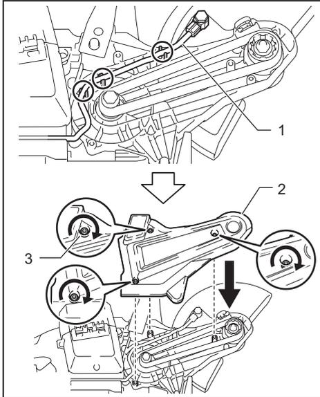
► 1. Tubo 2. Cubierta 3. Perno de cabeza hexagonal
