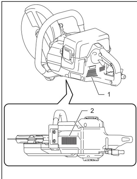
► 1. Ventilación de entrada 2. Ventilación de salida
